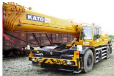
Краны на короткобазовом шасси
